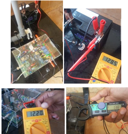
Gambar 14. Pengujian Dan Pengukuran Sensor Tegangan, ACS712 Pada Pompa Dan Baterai Saat Filter Air.
