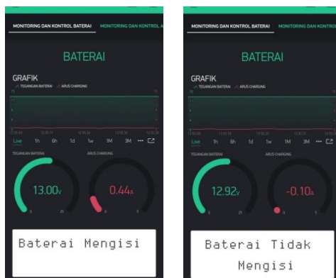
Gambar 18. Tampilan Tegangan Dan Arus Baterai Pada Blynk (Kiri Saat Charging) (Kanan Setekah Charging)
