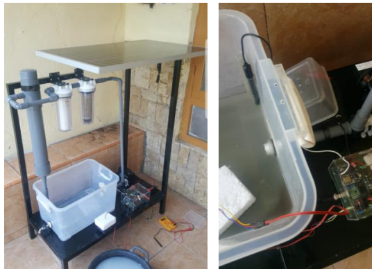
Gambar 12. Pengujian Monitoring Sensor Turbidty Dan pH Saat Filter Air
