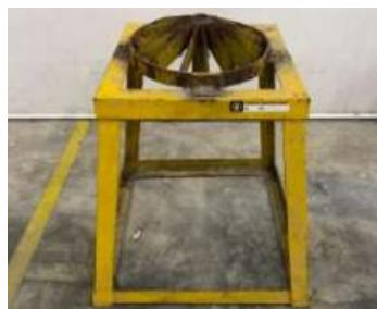
Gambar 2. Alat pemecah bilah bamboo
