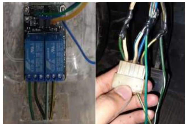
Gambar 7. Modul relay dan kunci kontak setelah dirangkai.
