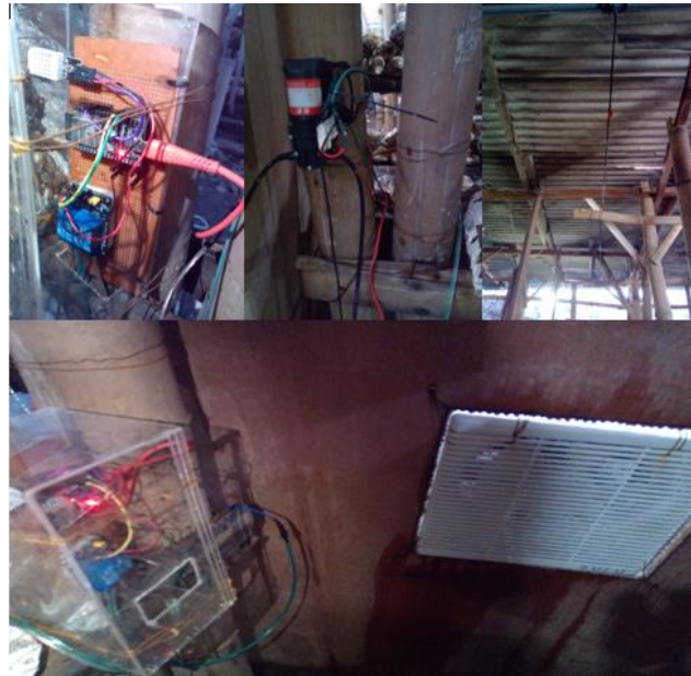
Gambar 6. Bentuk fisik alat monitoring suhu dan kelembaban
