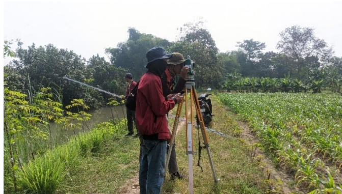
Gambar 4. Pengukuran Elevasi Menggunakan Alat Sokkia DT-240 (Digital Theodolite)
